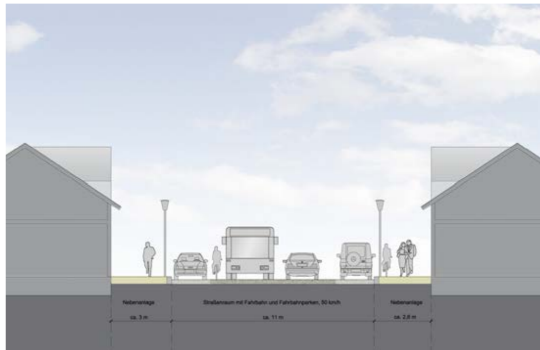
Regelschnitt durch den Straßenraum, Bestand (links) und Planung (rechts), M 1:100 im Original
